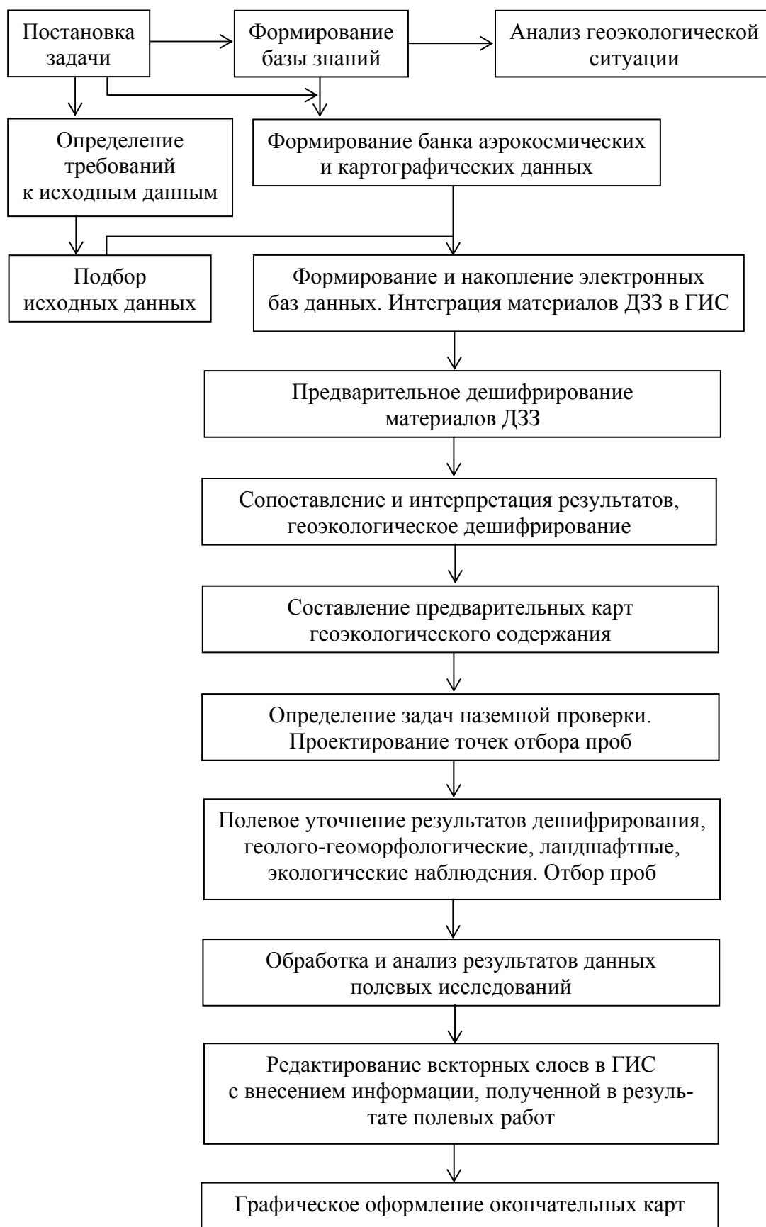
Рис. 3. Принципиальная технологическая схема обработки и интерпретации ДДЗ при использовании для целей экологического мониторинга
